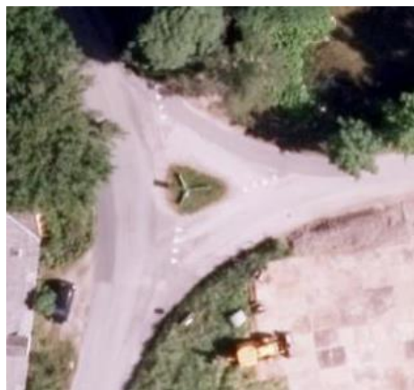
Figur 7-7 Krydset Assentorpvej/Stenmaglevej. Etablering af en minirundkørsel vil dæmpe hastigheden på Assentorpvej. Ortofoto COWI.
